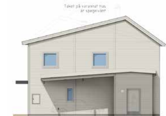
Gavelfasad med förråd och carport
